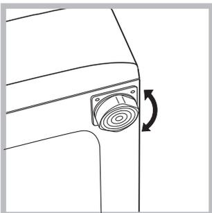
2. Se o pavimento não for perfeitamente horizontal, para compensar qualquer irregularidade, desatarraxe ou atarraxe os pés dianteiros (veja a figura); o ângulo de inclinação, medido no plano de trabalho, não deve ultrapassar 2°.
